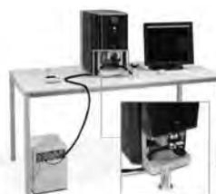
avec une précision de ±1,5°C et une vitesse de 20°C maximum par minute, selon la masse de l'échantillon. Le porte-échantillon est refroidi par une arrivée d'eau pour une excellente stabilité grâce à une unité de refroidissement autonome. Le porte-échantillon à température contrôlée peut être installé sur toutes les versions du Phenom G2.
